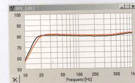
Tieftonsimulation entspr. d. Gehäuseempfehlung mit 0,2 Ohm (rot) und xx Ohm (schwarz) Widerstand im Signalweg
