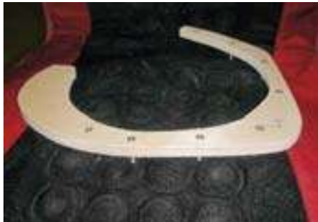
По этим размерам вырезается полукольцо наружной части подиума
