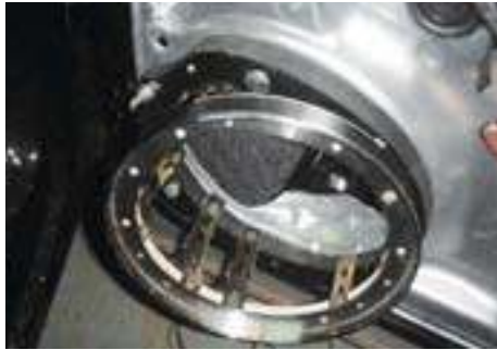
Фанерная подошва и металлическое опорное кольцо НЧ-динамика
