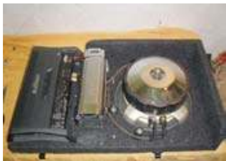
Снова он, с компонентами (собственно сабвуфер, его личный усилитель и буферная ёмкость)
