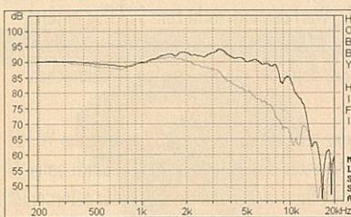
**Schalldruck-Frequenzgang in unendlicher Schallwand axial und unter 30°**
