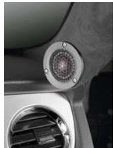
Пищалки Scanspeak (одни из самых компактных) установлены в стойках «по-процессорному»
